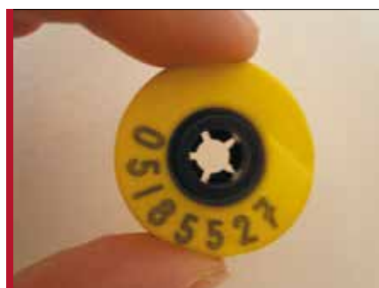
Transponder för hästidentifiering i foderstationerna
